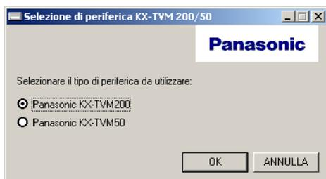
3. La prima volta che si avvia la Consolle di manutenzione KX-TVM, viene visualizzata la finestra Imposta parametri predefiniti. Selezionare Tipo TVM, Tipo PBX e Modalità di integrazione. Modificare i parametri predefiniti elencati nella finestra se necessario, quindi fare clic su **OK**.
